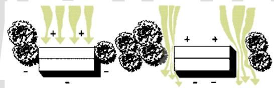
Figura 3.- Dirección del aire en movimiento con relación a la volumetría y vegetación
